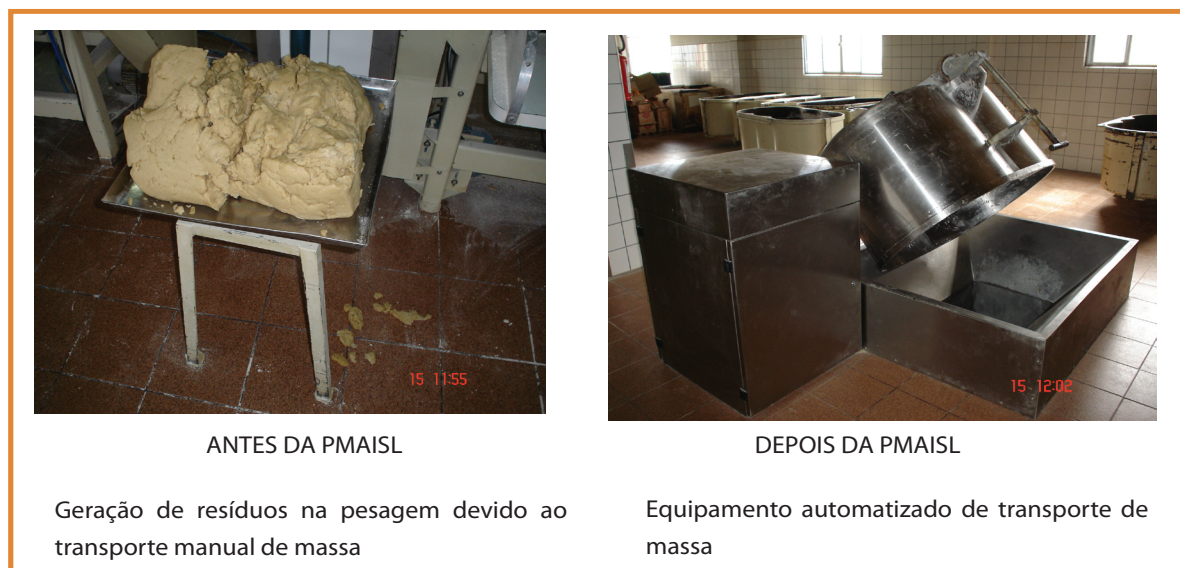
Figura 31: Situação antes e depois da PmaisL
