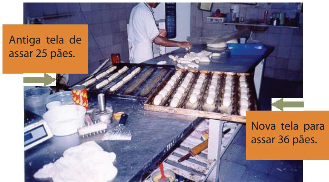
Figura 26 – Substituição das telas acondiciona-
